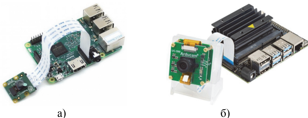
Рисунок 1 – Компьютер Raspberry Pi (а) и компьютер Jetson Nano (б) с подключенными CSI камерами
