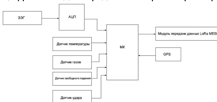
Рисунок 1 – Структурная схема умного строительного шлема
