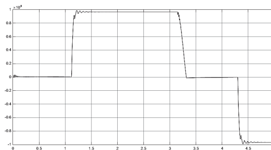
Рисунок 3 – График изменения перепада давления в гидроцилиндре
