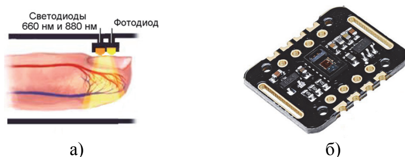
Рисунок 1 – Принцип работы (а) и модуль датчика MAX30102 (б)
