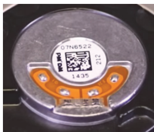
Рисунок 1 – Бесколлекторный двигатель от привода HDD с напряжением 12 В и мощностью около 4 Вт
